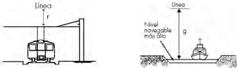
Figura 13. 4. Distancia “f” y “g” para cruces con ferrocarriles y ríos
